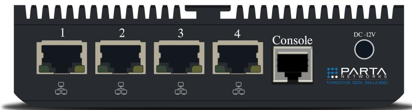
Targitas SDX 50-LC16D; Yazılım Tanımlı Ağ mimarisine sahip, içinde MPLS Router, Next Generation Firewall, SD-WAN, NAC, NDR, Hotspot ve 5651 loglama bileşenlerini barındıran, Multi-Tenant yapıda çalışan, hepsi bir arada ağ ve ağ güvenliği çözümüdür. Full API desteği sayesinde 3. parti sistemlere kolaylıkla entegre olabilir.
